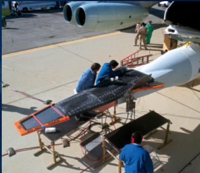
KOEKONE X-43A (musta osuus) kiinnitettyinä modifioituihin Pegasus-rakettiin. Yhdistelmä lähti matkaan lentokoneen siiven alta, ja oikeassa nopeudessa X-43A erkani raketista ja scramjet-moottori käynnistettiin.
