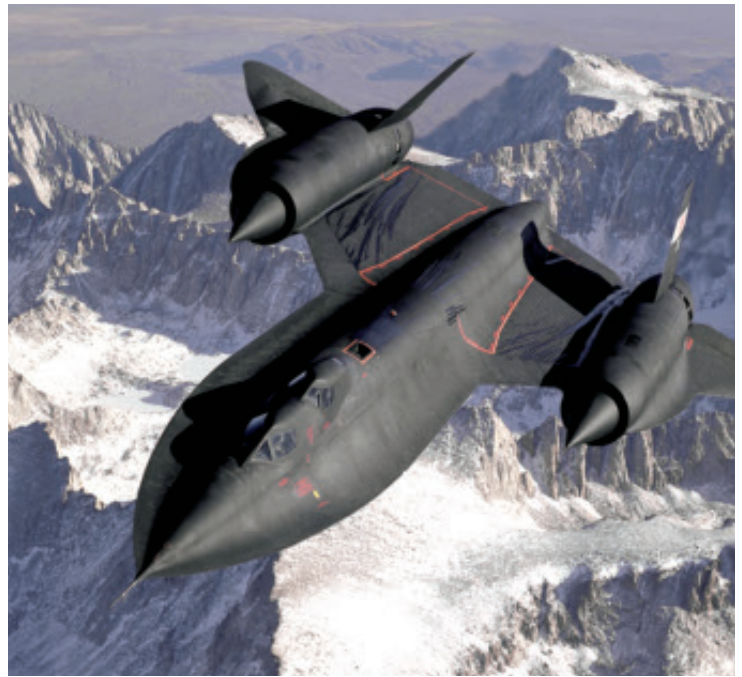
VAKOILUKONE SR-71 pitää hallussaan perinteisten suihkumoottorikoneiden nopeusennätystä. Senkin moottoreissa on jo hieman patoputkimoottorin piirteitä, kuten imuaukkojen kartioista voi päätellä.
